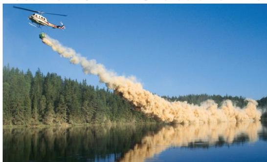
Le chaulage consiste à déverser du carbonate de calcium, un produit qui neutralise l'acidité des eaux de surface. Le carbonate de calcium réagit avec l'acide, ce qui augmente le pH. Un chaulage à la calcite permet d'augmenter graduellement le pH des eaux, les concentrations en métal lourd diminuent de nouveau dans des limites sûres pour la vie des poissons. Le nombre d'espèce de poissons augmente ainsi que le nombre de plancton de même que la production totale de matière vivante.
