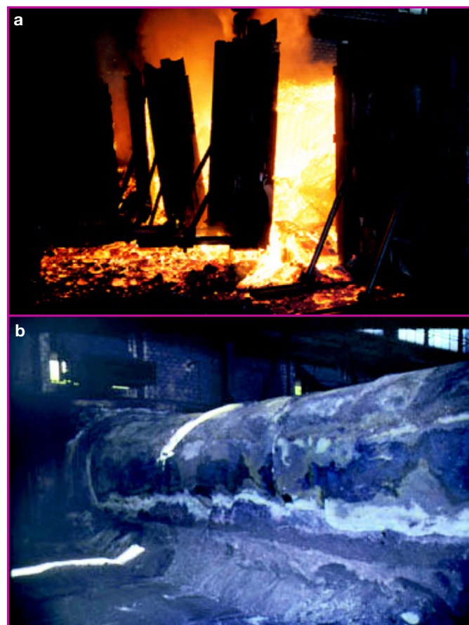
Figure 1 - a) Début et b) fin de la phase de refroidissement suivant le traitement de graphitisation.
